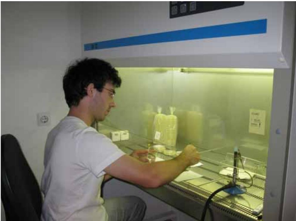
Figura 3.1 - La predisposizione dei campioni è stata condotta all'interno della cappa a flusso laminare verticale al fine di mantenere un ambiente il più possibile sterile.
